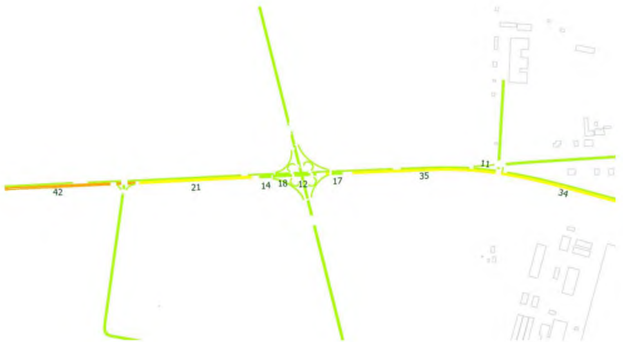
Рисунок 28 – Схематичное изображение транспортной развязки на пересечении а/д Р-178 и проектируемого ближнего западного обхода г. Ульяновск на цифрограмме модельного расчета уровня загрузки УДС
