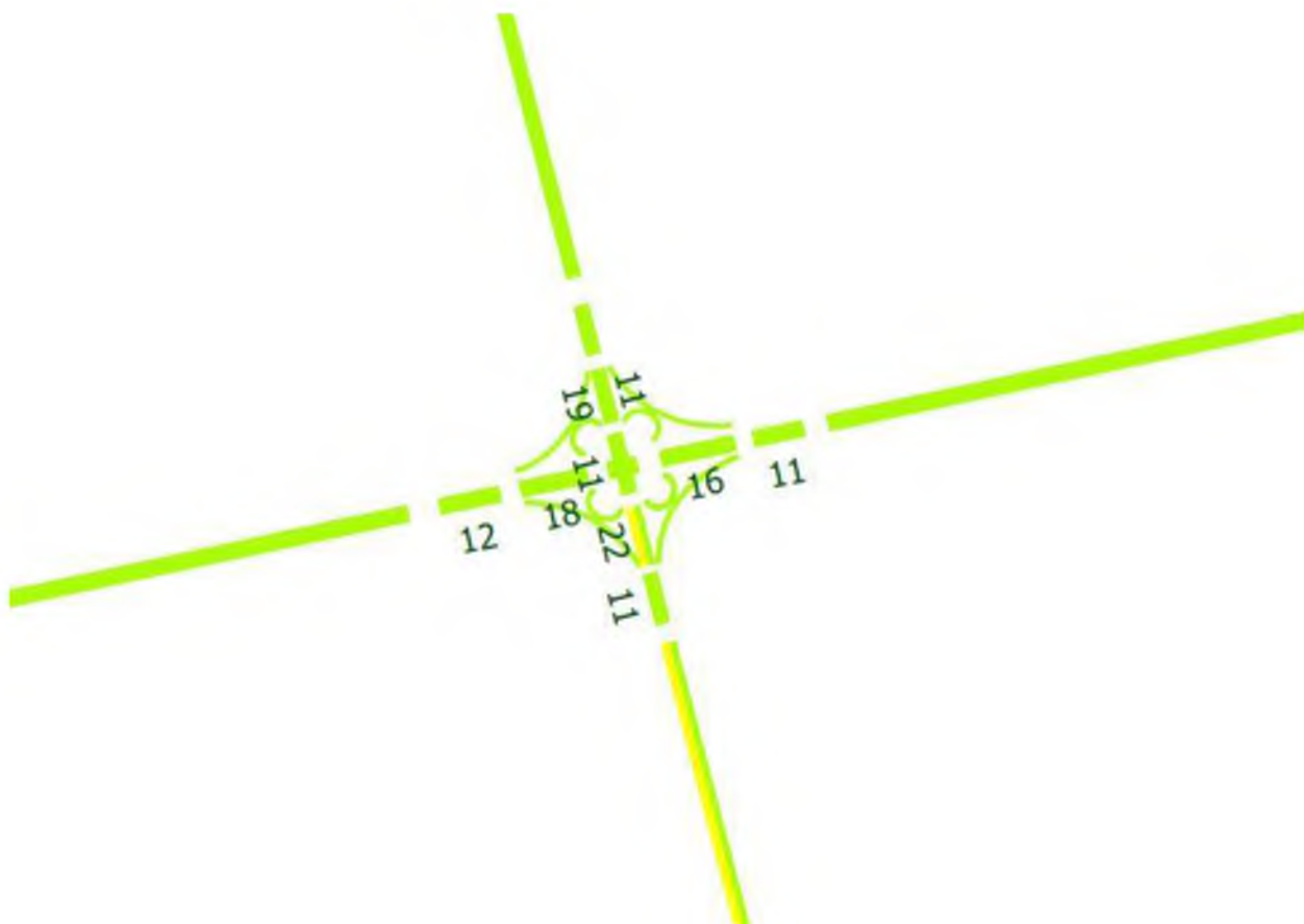
Рисунок 24 – Схематичное изображение транспортной развязки на пересечении а/д А-151 и проектируемого северного обхода г. Ульяновск на цифrogramме модельного расчета уровня загрузки УДС
