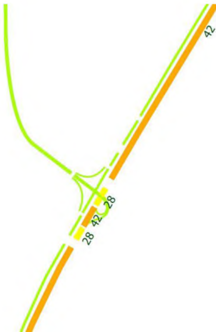
Рисунок 27 – Схематичное изображение транспортной развязки на пересечении а/д Подъезд к г. Ульяновск от а/д М-5 «Урал» и проектируемого ближнего западного обхода г. Ульяновск на цифрограмме модельного расчета уровня загрузки УДС
